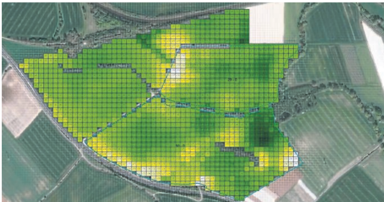
Ein digitalisierter Acker im Kreisteil Hofgeismar: Für die einzelnen Parzellen können Dünger- und Aussaatmengen individuell festgelegt werden. Mit den Daten werden die Maschinen auf dem Feld genau gesteuert. FOTOS: NEXT FARMING
